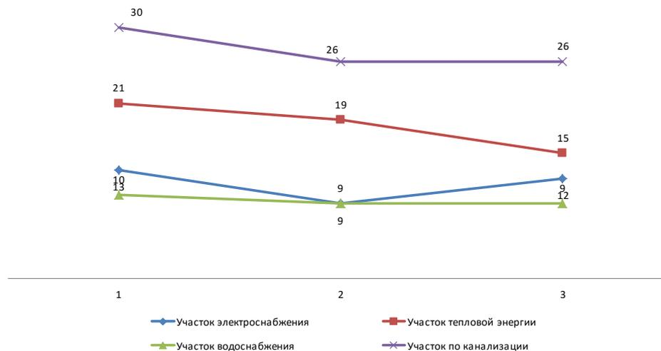
Основной причиной аварийности является высокий уровень изношенности тепловых, электрических, водопроводных и канализационных сетей,
